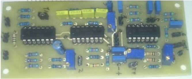
Fig. 13. Circuit ECG Design
