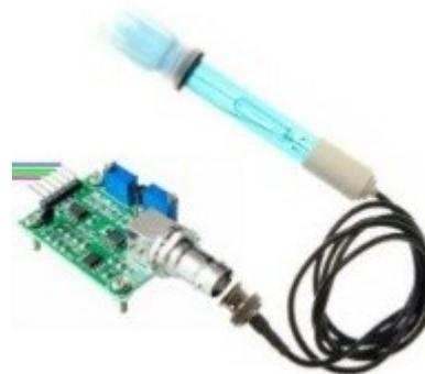
Fig. 2. pH Meter Module Sensor SKU-016
